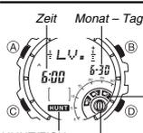
Der Jäger/Angler-Modus zeigt einen Indikator an, an dem in fünf Stufen der Eignungsgrad eines bestimmten Datums und Zeitpunkts (Minute 00 bis Minute 59 einer bestimmten Stunde) für Jagen bzw. Angeln ablesbar ist. Dieser Modus kann auch zum Anzeigen der Monddaten (Mondalter und Mondphase) für ein bestimmtes Datum verwendet werden.
