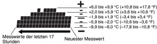
Die horizontale Achse der Grafik ist die Zeitachse. Die Säule ganz rechts bildet der jüngste gespeicherte Temperaturwert und die Säule ganz links der 17 Stunden zurückliegende älteste Wert (1 Säule = 1 Stunde). Auf der vertikalen Achse der Grafik ist die relative Änderung von einer Stunde zur nächsten dargestellt.
