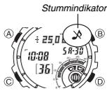
Wenn einer der Knöpfe der Uhr betätigt wird, ertönt ein Bedienungskontrollton. Dieser Kontrollton kann beliebig ein- und ausgeschaltet werden.
