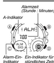
Wenn die Alarmfunktion eingeschaltet ist, ertönt auf Erreichen der Alarmzeit ein Piepsignal. Sie können auch ein stündliches Zeitsignal ausgeben lassen, bei dem die Uhr jede volle Stunde mit zwei Pieptönen meldet.
