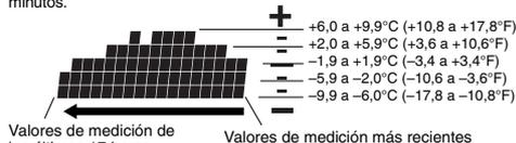
El eje horizontal del gráfico representa la hora. La columna del extremo derecho es el valor de temperatura más reciente de la memoria, mientras que la columna del extremo izquierdo es el valor de temperatura guardado aproximadamente 17 horas antes (1 punto=1 hora). El eje vertical del gráfico representa el cambio relativo de una hora a la siguiente.
