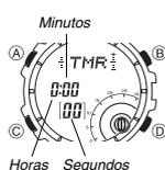
Puede ajustar el temporizador de cuenta regresiva dentro de un rango de un minuto a 100 horas. Suena una alarma cuando la cuenta regresiva llega a cero.
