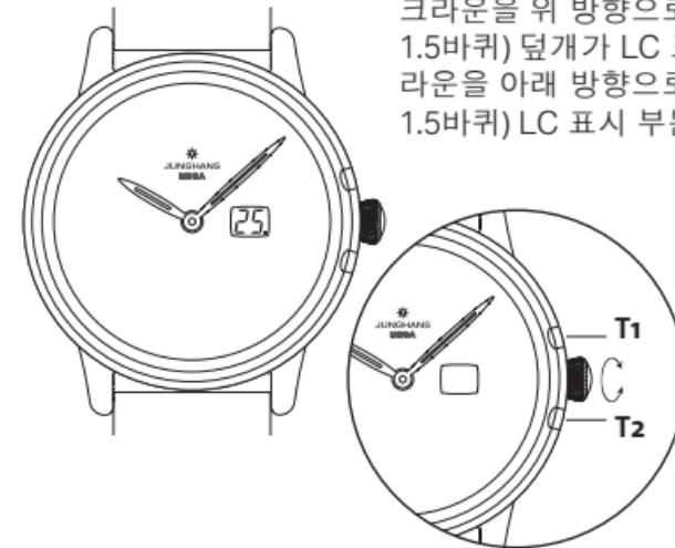
크라운을 위 방향으로 돌리면 (T1 방향으로 약 1.5바퀴) 덮개가 LC 표시 부분 위로 갑니다. 크라운을 아래 방향으로 돌리면 (T2 방향으로 약 1.5바퀴) LC 표시 부분을 다시 열 수 있습니다.
