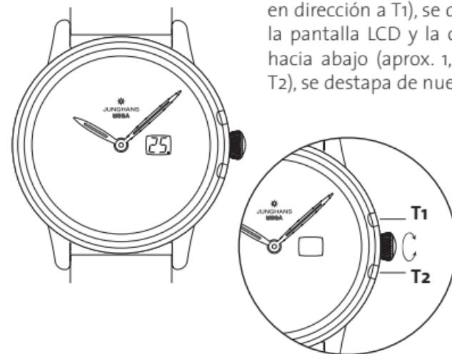
Si gira la corona hacia arriba (aprox. 1,5 vuelta en dirección a T1), se desplaza una tapa sobre la pantalla LCD y la oculta. Si gira la corona hacia abajo (aprox. 1,5 vuelta en dirección a T2), se destapa de nuevo la pantalla LCD.
