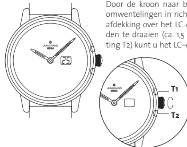
Door de kroon naar boven te draaien (ca. 1,5 omwentelingen in richting T1) schuift zich een afdekking over het LC-display. Door naar beneden te draaien (ca. 1,5 omwentelingen in richting T2) kunt u het LC-display weer openen.
