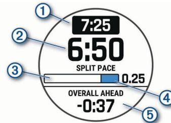
Auf dem Gerät werden die Ziel-Teilstreckenpace ①, die aktuelle Teilstreckenpace ②, der Fortschritt für den Abschluss der Teilstrecke ③, die in der Teilstrecke verbleibende Distanz ④ und der zeitliche Vorsprung bzw. Zeitrückstand zur Zielpace ⑤ angezeigt.
